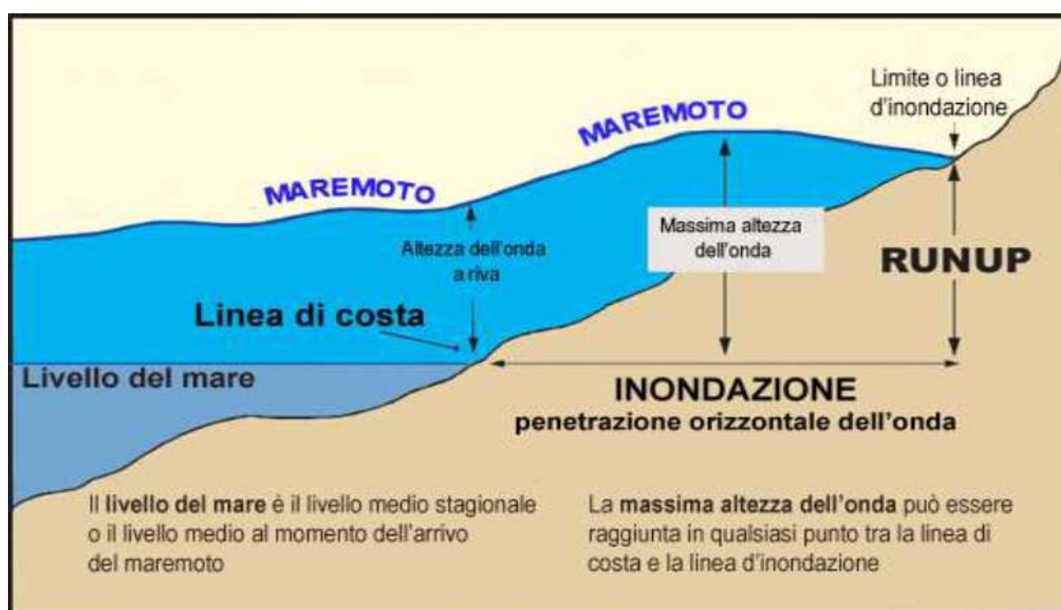
Fig. 36 - Schema illustrante i parametri da tenere in considerazione in caso di maremoto
